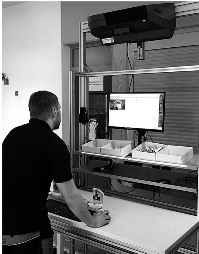
*Jeder Arbeitsschritt wird im Vorfeld einprogrammiert. Anschließend begleitet Ulixes die Nutzer vollautomatisch durch die Anleitungen.*
